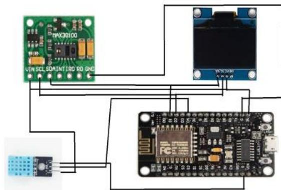
LINE DIAGRAM OF MAX30100 & DHT11
